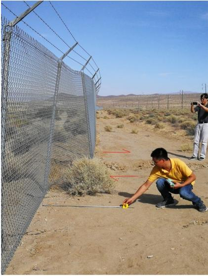
M7.1级地震地表破裂破坏海军军事基地围栏
